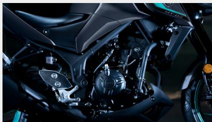
**Dvocilindrični agregat obujma 321 ccm, izdašnog okretnog momenta**
